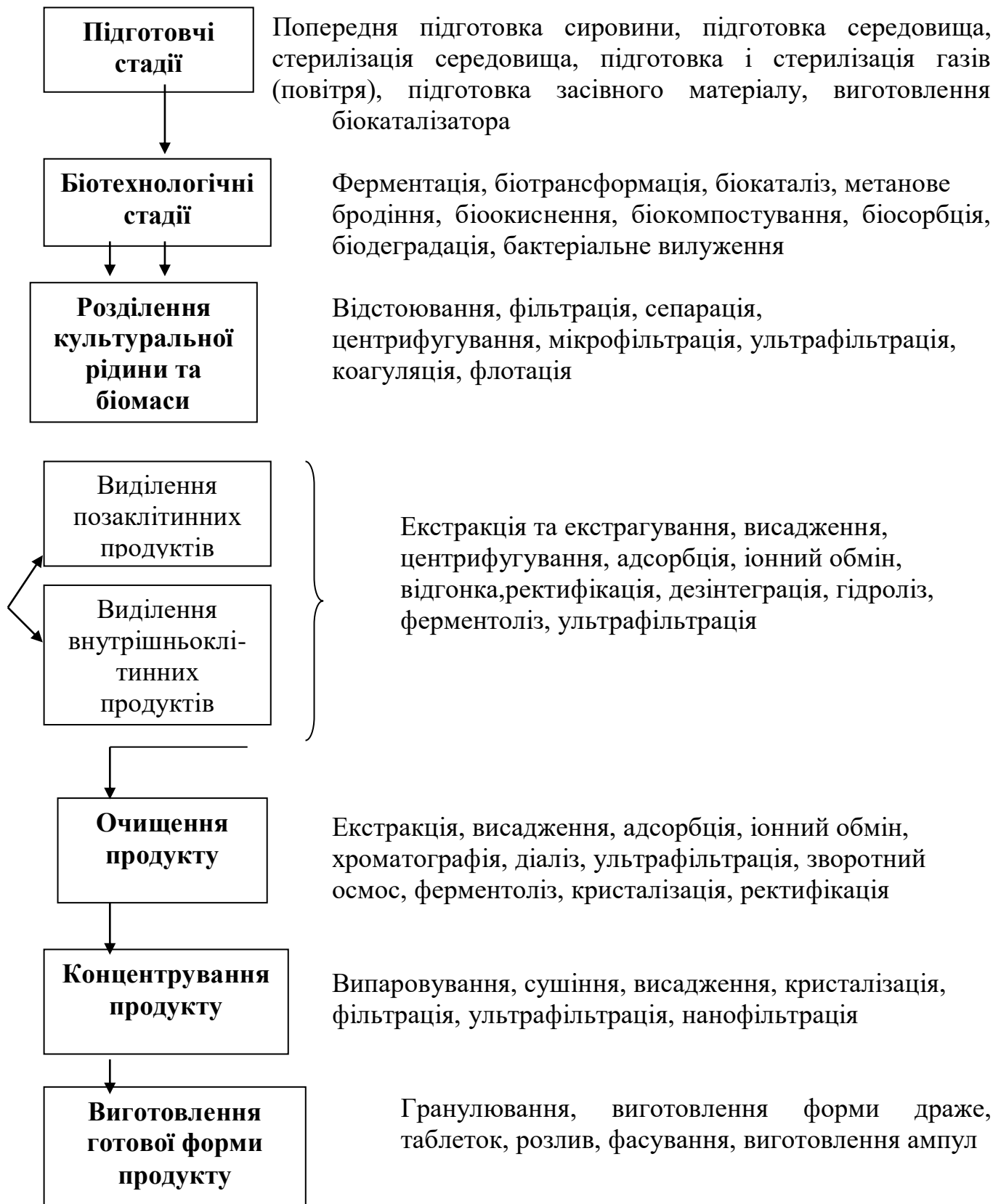
Рис. 2. Типова узагальнена схема основних стадій біотехнологічного виробництва
