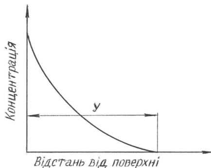
Рис 10.2. Зміна концентрації дифундуючого елемента по перерізу деталі: y – товщина дифузійного шару
