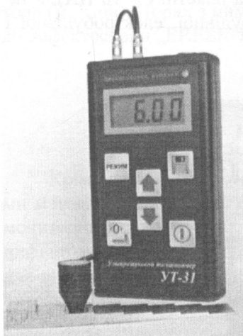
Рисунок 5.37 Ультразвуковий товщиномір УТ-31
