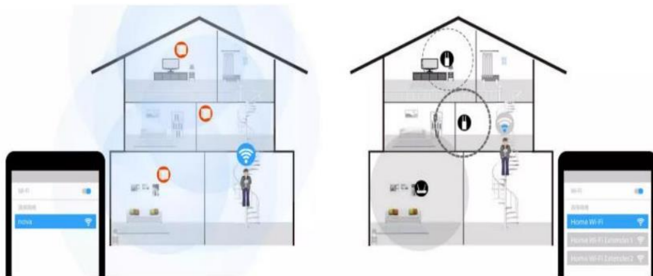
Рисунок 5 – Зони покриття Mesh мережі та звичайної Wi-Fi мережі
