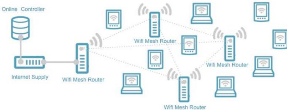
Рисунок 3 – Схема системи Mesh
