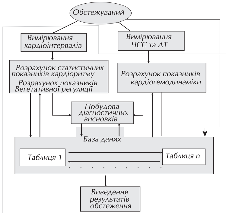
Рисунок 25.47 — Функціональна схема, що демонструє методику автоматизованої експрес-діагностики стану серцево-судинної та вегетативної нервової систем
