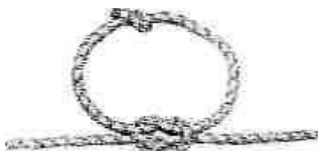
Рис. 3.8 а. Прямий вузол для виключення зіпсованої до навантаження частини мотузки
