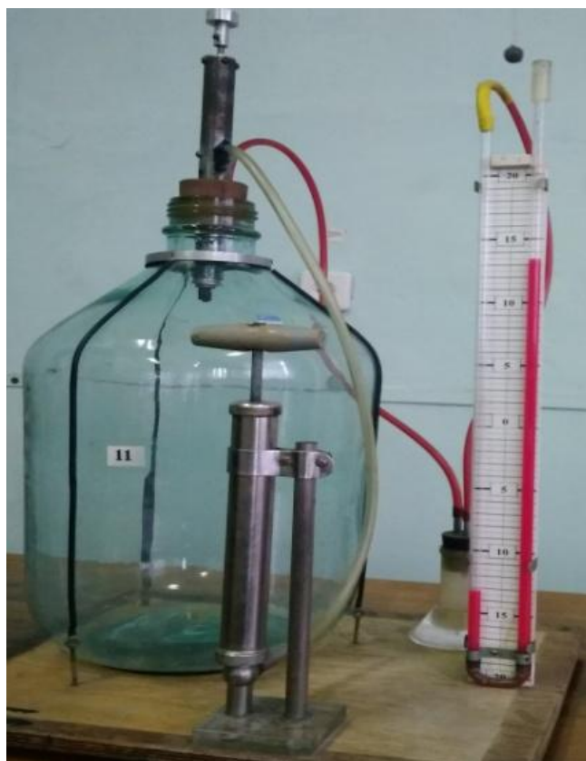
Рисунок 2.2 – Експериментальне визначення різниці рівнів h_1
