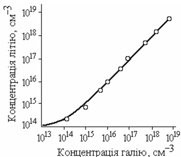
Рисунок 1.10 – Залежність розчинності літію в германії від вмісту в ньому галію (при кімнатній температурі)
