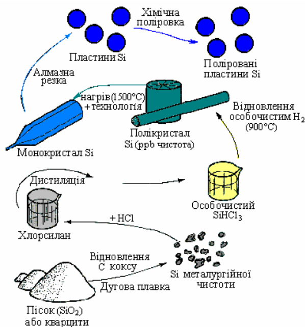
Рисунок 4.2 – Схема отримання напівпровідникового кремнію
