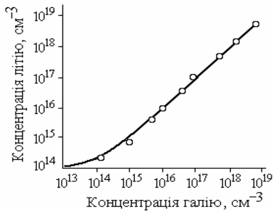
Рисунок 4.3 – Залежність розчинності літію в германії від вмісту в ньому галію (при кімнатній температурі)
