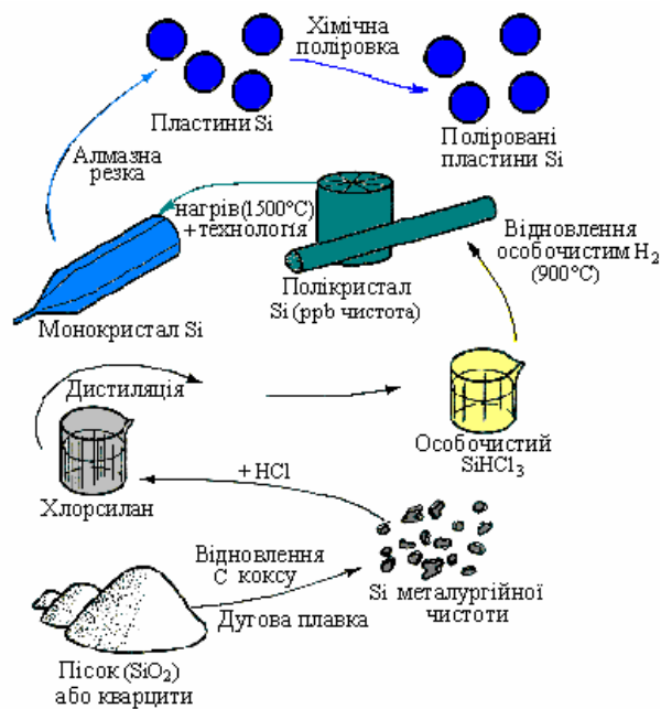
Рисунок 5.2 – Схема отримання напівпровідникового кремнію
