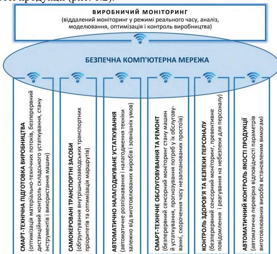
Рисунок 1.2 – Типова схема смарт-заводу на базі IIoT
