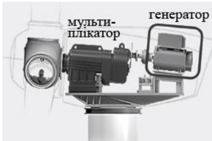
Рис. 8.8. Схema з'єднання валу вітроколеса, мультиплікатора і генератора
