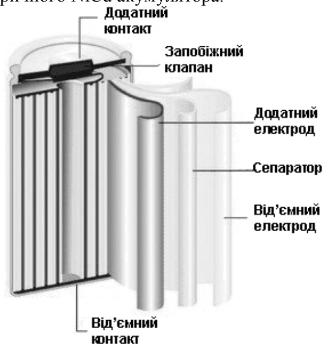
Рис. 2.3. Конструкція циліндричного NiCd акумулятора
