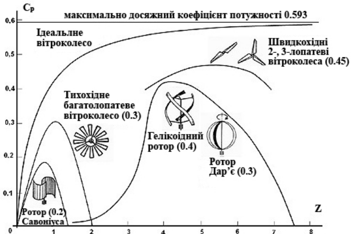
Рис. 8.11. Значення коефіцієнту потужності різних типів вітроколес
