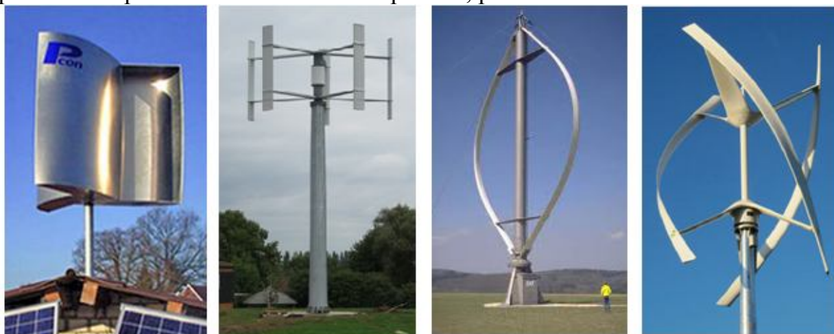
а) з ротором Савоніуса; б) з ротором Масгрува; в) з ротором Дар'є; г) з гелікодіним ротором Рис. 8.3. ВЕУ з вертикальною віссю обертання
