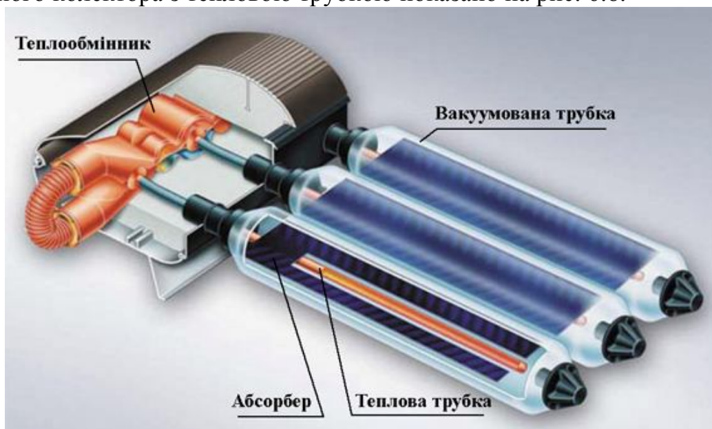
Рис. 6.8. Вакуумний колектор з тепловою трубкою
