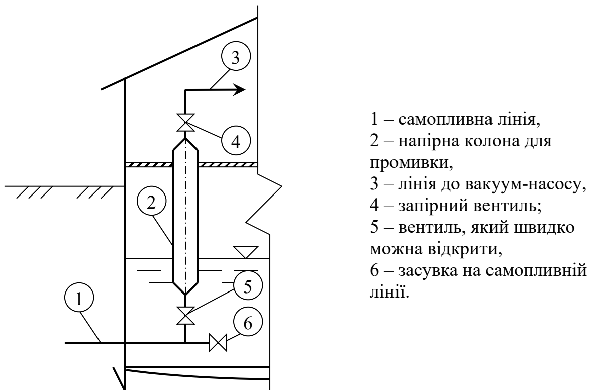
Рисунок 3.9 – Схема гідроімпульсної промивки самопливних і сифонних ліній
