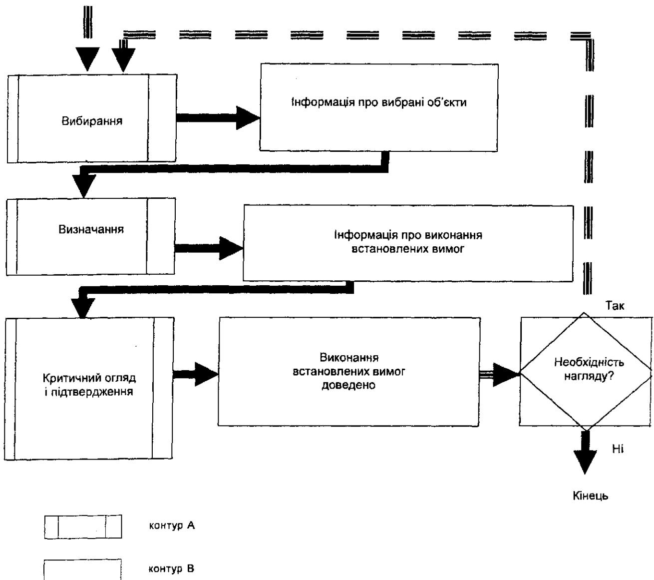
Рисунок А.1 — Функційний підхід до оцінювання відповідності
