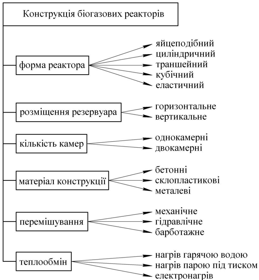
Рисунок 3 – Класифікація біогазових реакторів за конструктивними ознаками
