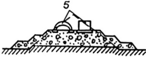
Рисунок 2.143 – Схеми будівельного напрямку рекультивациі шахтних відвалів: а) цивільне будівництво; б) промислове будівництво; в) рекреаційне будівництво; 1 – породний відвал; 2 – житлові будинки; 3 – спортивні споруди; 4 – будівлі терасового типу; 5 – промислові будівлі та споруди; 6 – паркові споруди
