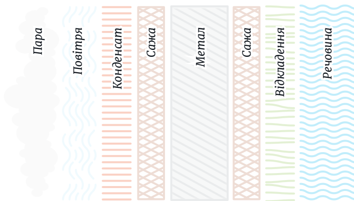
Рисунок 26: Перешкоди для ефективної передачі тепла
