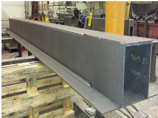
Рисунок 1.8. Пример перекрытий пониженной высоты на основе HQ- и WQ-балок
