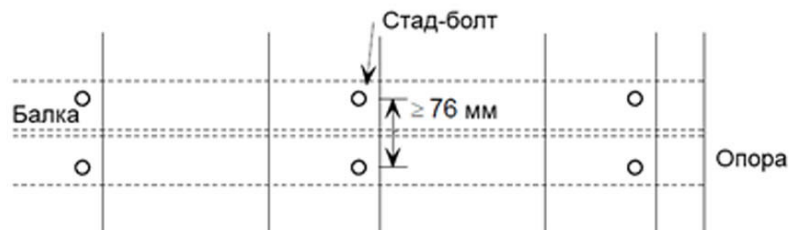
в) По два стад-болта в гофре параллельно
