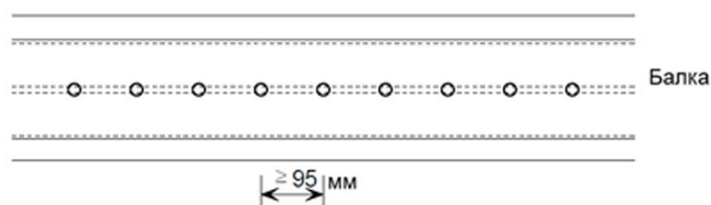
е) Расположение стад болтов при расположении гофров параллельно балкам
