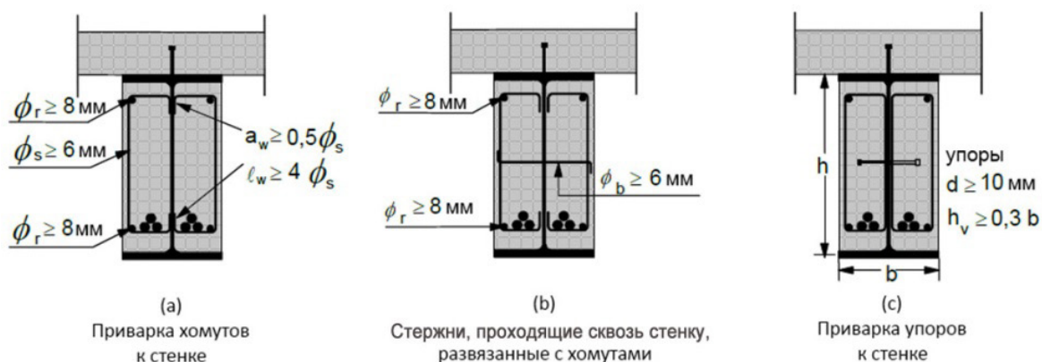
Рисунок 9.11. Крепление бетонного заполнения к стальной балке
