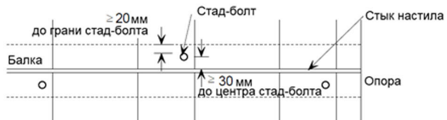
г) Стык настила (правильное расположение одиночных стад-болтов)
