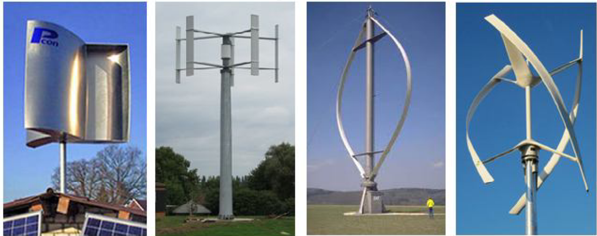
а) з ротором Савоніуса; б) з ротором Масгрува; в) з ротором Дар'є; г) з гелікоїдним ротором Рис. 8.3. ВЕУ з вертикальною віссю обертання
