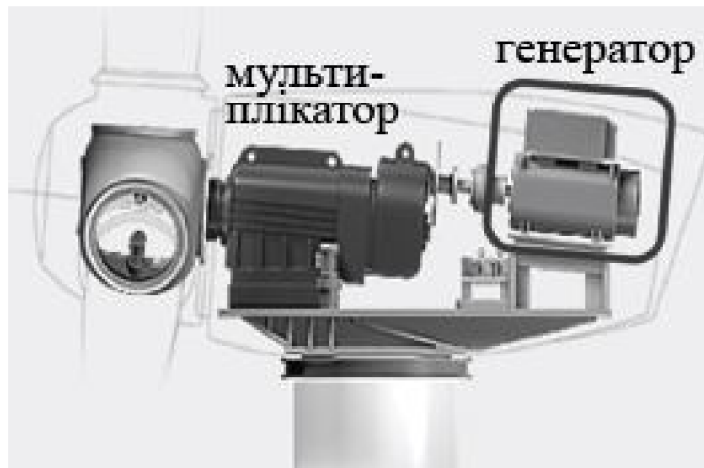
Рис. 8.8. Схема з'єднання валу вітроколеса, мультиплікатора і генератора
