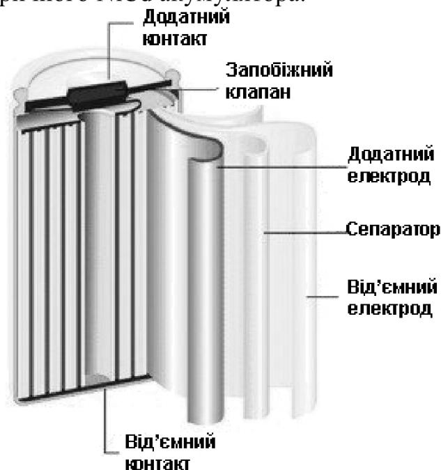
Рис. 2.3. Конструкція циліндричного NiCd акумулятора
