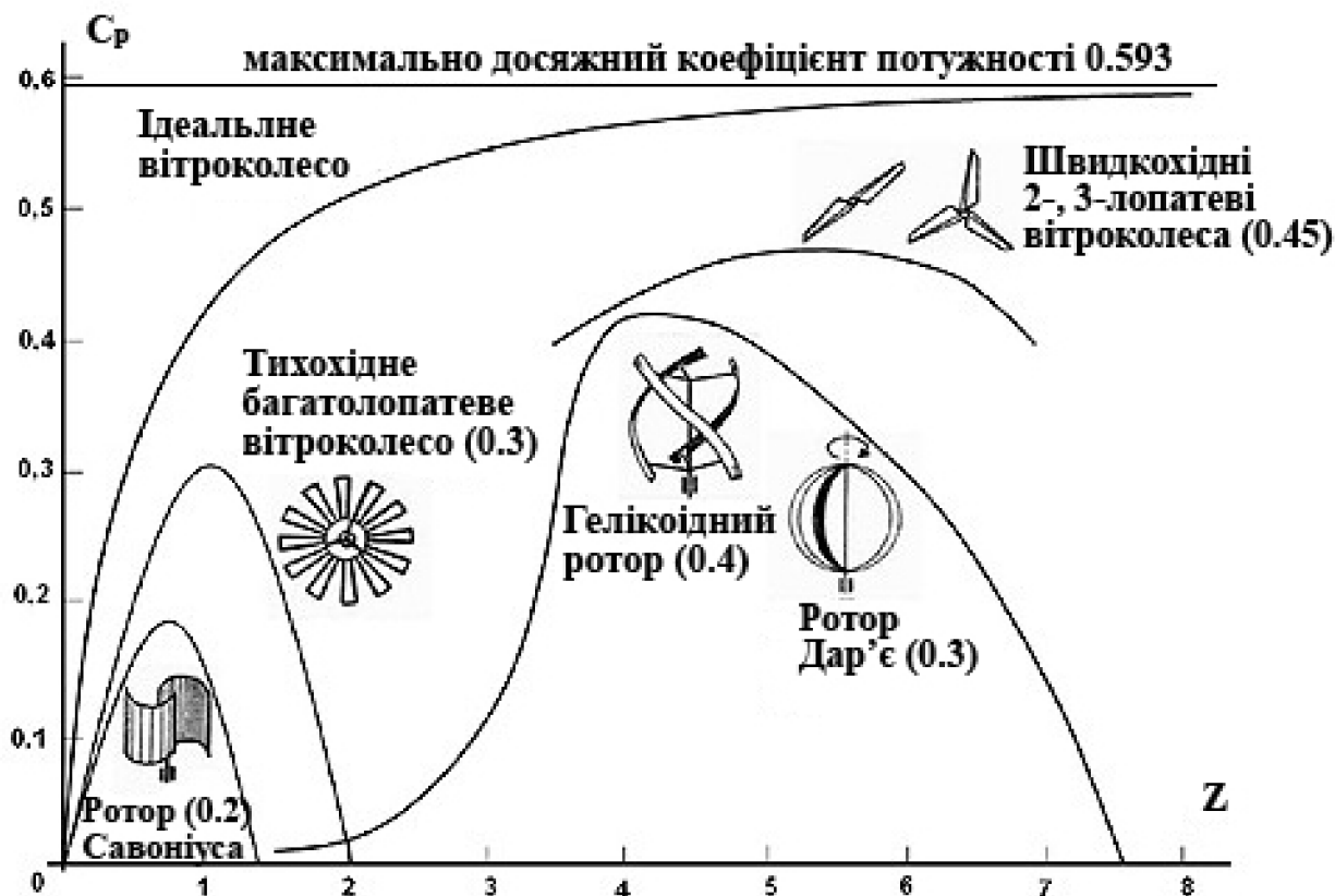
Рис. 8.11. Значення коефіцієнту потужності різних типів вітроколес
