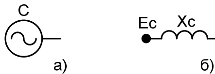
Рис.17 Електрична (а) та заступна (б) схеми еквівалентної енергосистеми
