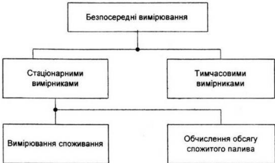
Рис. 2.2 Класифікація методів безпосереднього (прямого) вимірювання.
