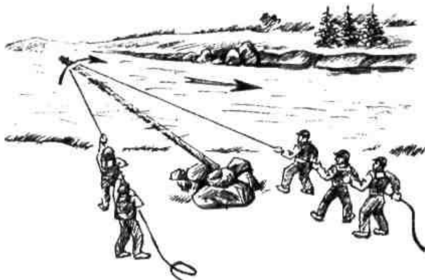
Рис. 4.10. Укладання колоди з використанням течії
