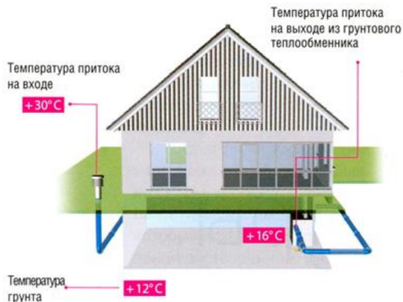
Рисунок 1.10 – Схема роботи підземної вентиляції влітку
