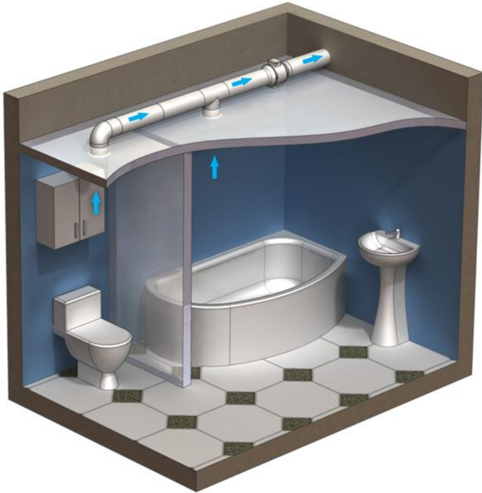
Рисунок 3.1 – місцева система вентиляції
