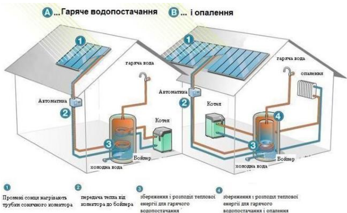
Рисунок 2.4 – Схема комплектації сонячних колекторів
