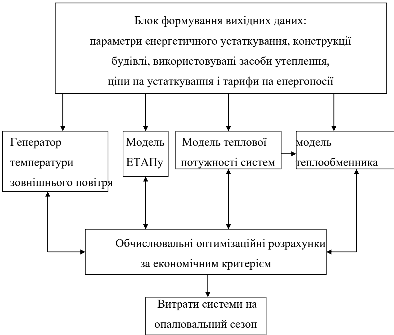
Рис. 4.3. Структура моделі комбінованої системи опалення.
