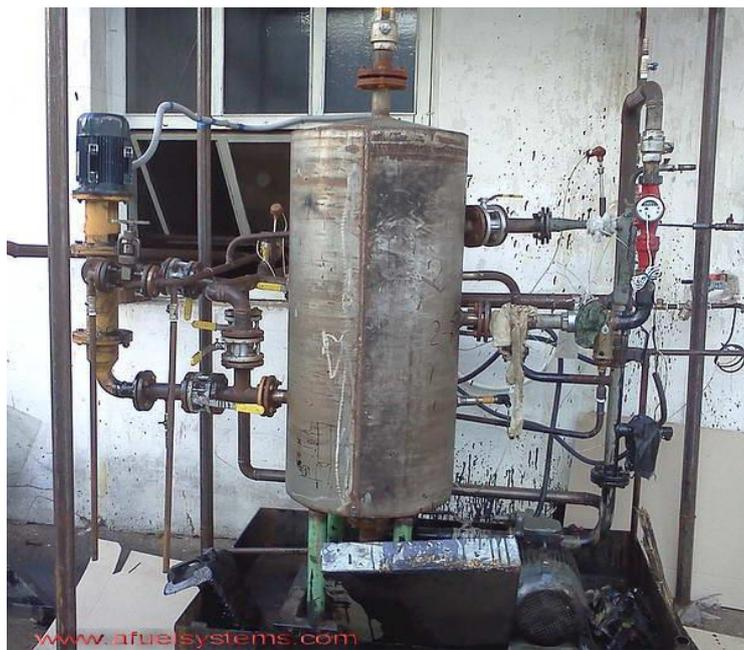
Рисунок 2. Общий вид эмульгатора мазута
