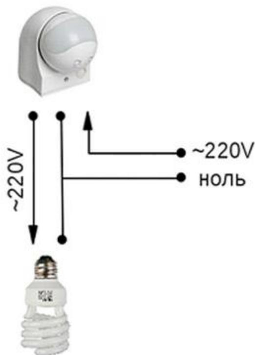
Рисунок 1. Схема подключения датчика движения
