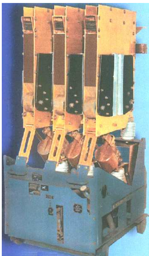
Рис.18 Електромагнітний вимикач (1 – ізолятори, 2 – система переміщення рухомого контакту, 3 – дугогасильна камера з електромагнітом)
