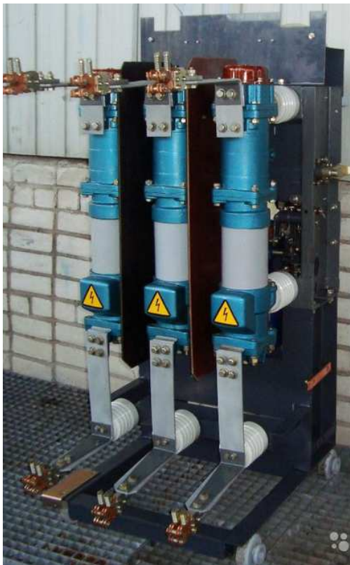
Рис.16 Маломасляний вимикач (1 – корпус, 2 – ізолятори, 3 – кріплення вимикача, 4 – тяга, 5 – механізм переміщення тяги, 6 – привод)
