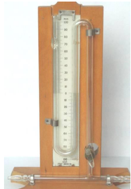
Рис. 5.3. Модель рідинного манометра
