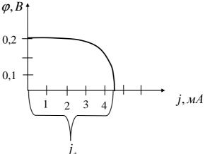
Вентильная фото-э.д.с. является источником напряжения в «солнечных батареях». При наличии микрогетеропереходов и барьерных слоев типа полупроводник-квазиметалл или иных барьеров в объеме неоднородного полупроводника суммарная  $\varphi_{\text{вент}}$  может оказаться весьма значительной. Этот эффект наблюдается и на барьере Шотки. Кроме того
