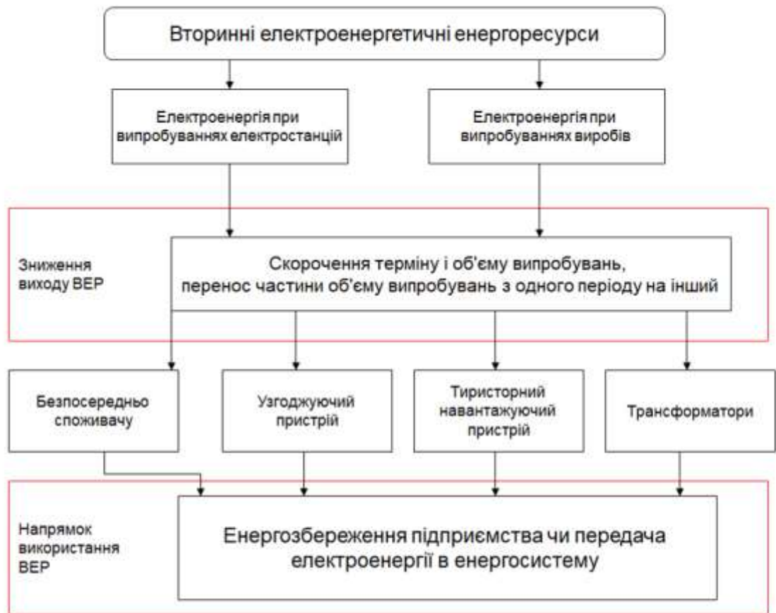
Рисунок 1.3 - Схема використання електроенергетичних ВЕР на підприємствах
