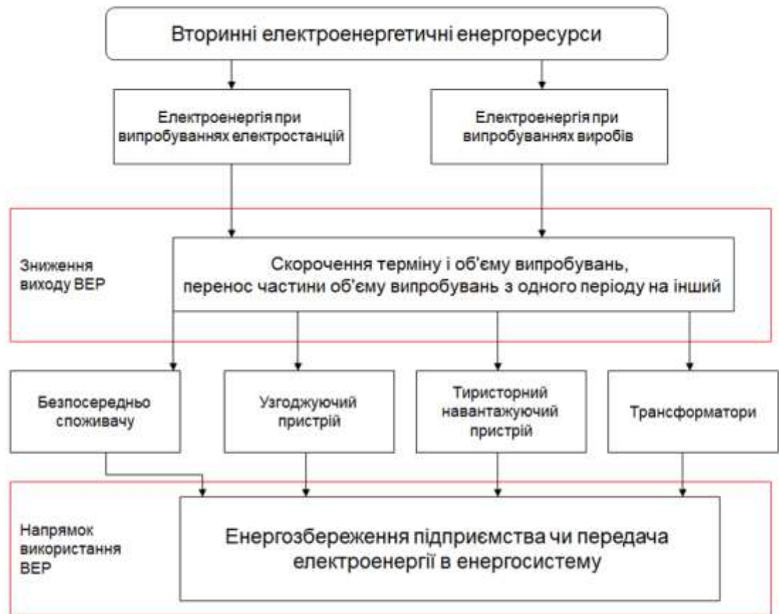
Рисунок 1.3 - Схема використання електроенергетичних ВЕР на підприємствах
