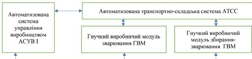
Рис. 1. Структура гнучкого виробничого комплексу
