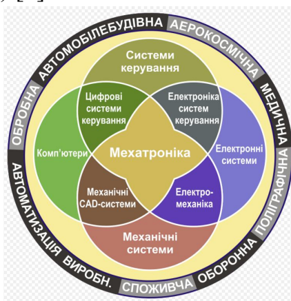
Рисунок 1.3 – Діаграма взаємоперетину різних галузей науки та техніки, на основі яких формується мехатроніка
