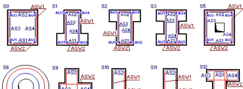
Рисунок 6.1 – Розташування арматури в залізобетонних перетинах стержнів.
