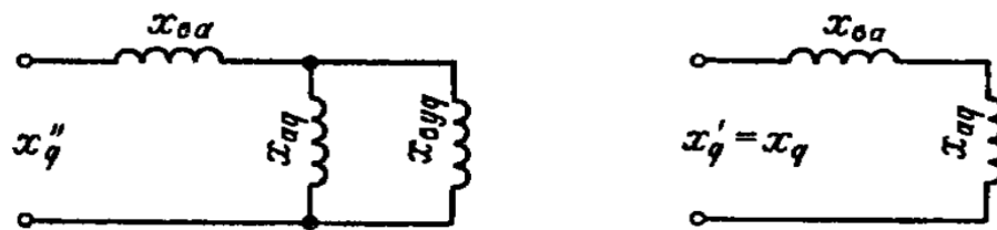
Рис. 3.46 - Схема заміщення синхронного генератора в поперековій осі за раптової зміни навантаження
