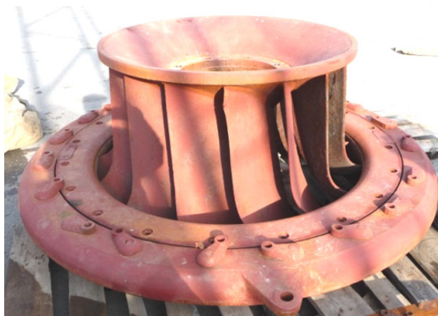
Рис. 2.34 – Робоче колесо низьконапірної радіально-осьової турбіни потужністю 150 кВт
