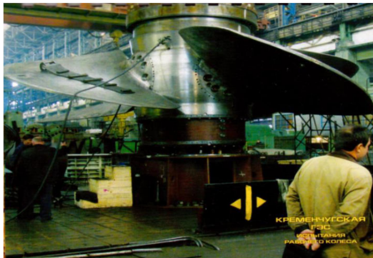
Рис. 2.33 – Робоче колесо низьконапірної пропелерної поворотно-лопатевої турбіни потужністю 60 МВт
