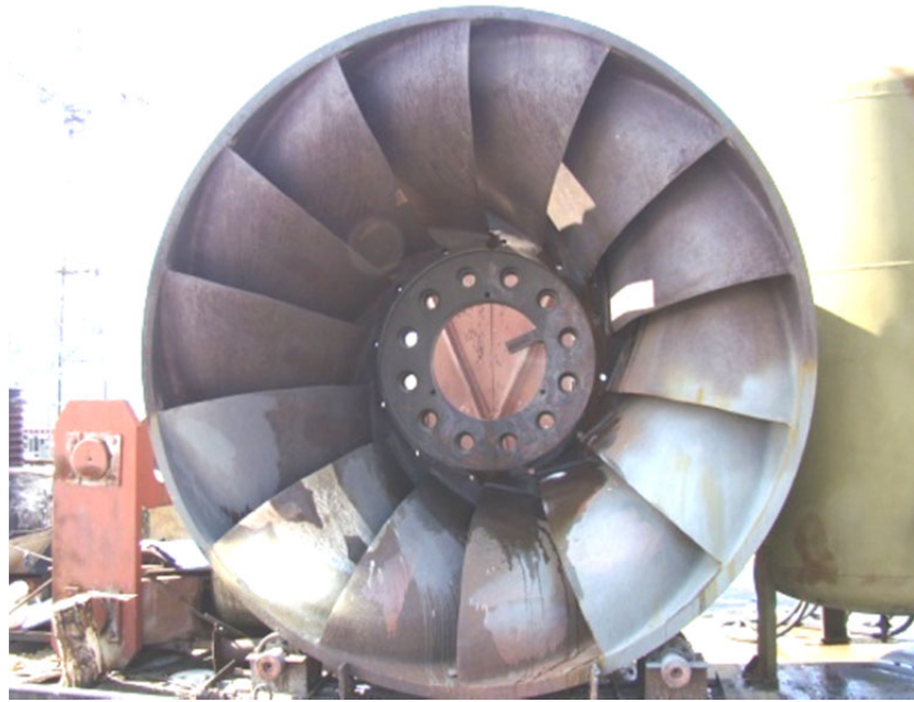
Рис. 2.35 – Робоче колесо високонапірної радіально-осьової турбіни потужністю 40 МВт
