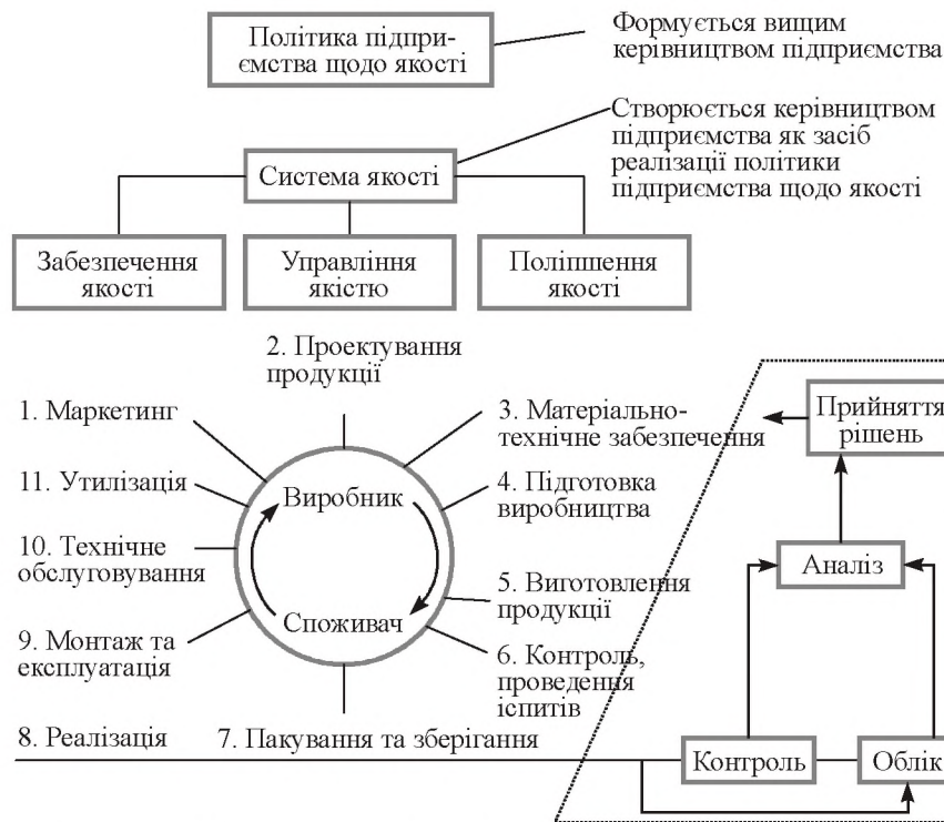
Рисунок 12 – «Петля якості» або типові стадії життєвого циклу продукції, на яких забезпечується її якість
