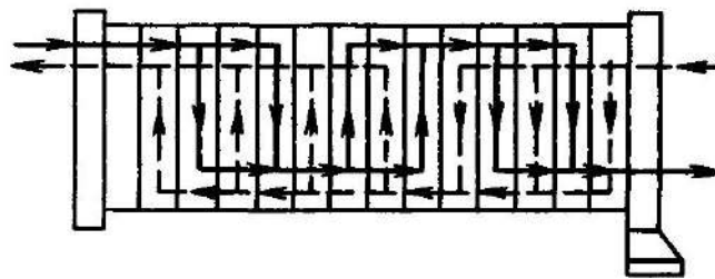
Рисунок 8.34 – Схема компоновання пластинчастого теплообмінника у два симетричні пакети
