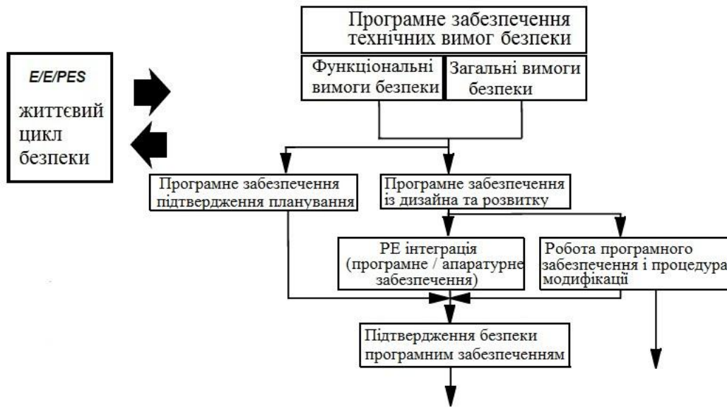
Рисунок 5.8 – Взаємодія моделей життєвого циклу електричної, електронної і програмованої електронної системи безпеки (Е / Е / PES) та програмного забезпечення
