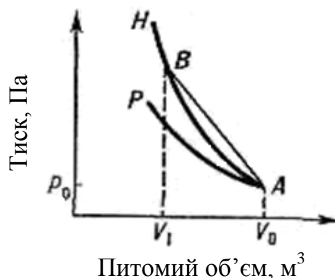
Рисунок 1.9 - Ударна адіабата H и адіабата Пуассона P , що проходять через початкову точку A вихідного стану
