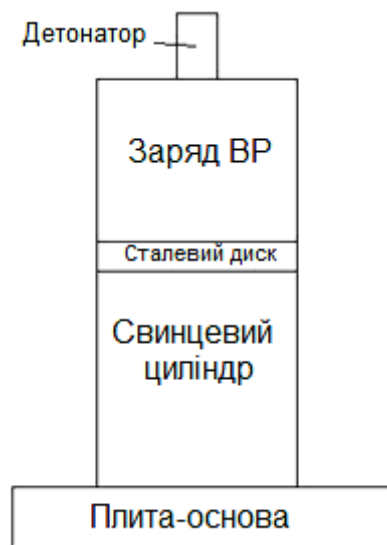
Рисунок 1.10 – Проба Гесса для визначення бризантності
