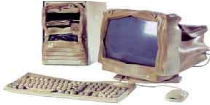
Рис. 11.1 Комп'ютер, пошкоджений внаслідок пожежі
