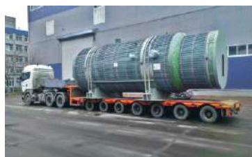
Транспортування гідроємності САОЗ для енергоблоку № 3 АЕС "Тяньвань" (Китай)
