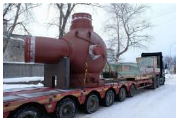
Циліндричний корпус ГЦН-195М з нижніми проставками для енергоблоку № 2 Ленінградської АЕС-2 (РФ)
