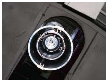
Захоплювач робочої штанги з вирівнюючим механізмом перевантажувальної машини МПС-В-1000 енергоблоку № 1 Волгодонської АЕС (РФ)
