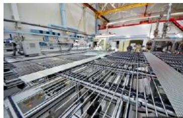
Цирконієві трубки в цеху виготовлення ТВЕЛів ПАО «Новосибірський завод хімконцентратів» (м. Новосибірськ, РФ)
