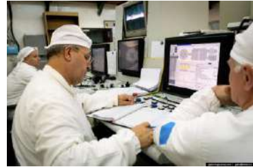
Пуルト керування перевантажувальною машиною МПС-1000 енергоблоку № 2 Балаковської АЕС (РФ)
