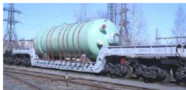
Транспортування компенсатора тиску для енергоблоку № 4 Ростовської АЕС (РФ), що виготовлений на ОАО “Петрозаводськ-маш” (м. Петрозаводськ, РФ)
