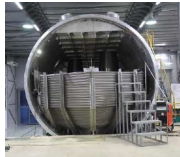
Трубний пучок парогенератора енергоблоку № 4 Ростовської АЕС (РФ)
