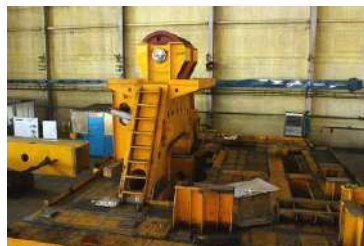
Виготовлення візка полярного крана на майданчику механоскладального цеху № 5 АО "Тяжмаш" (м. Сизрань, РФ)
