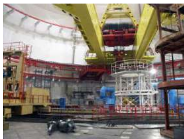
Полярний кран КМ 320+160/2x70 т енергоблоку № 1 Хмельницької АЕС (Україна)
