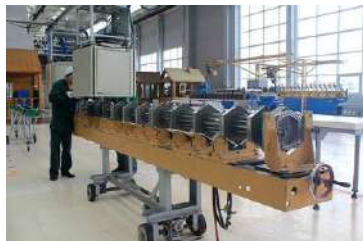
Аргонодугове електрозварювання нижніх кінців напрямних трубок ПС СУЗ з плитою нижньої опорної решітки на ПАО “Новосибірський завод хімконцентратів” (м. Новосибірськ, РФ)
