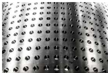
Зовнішня поверхня з отворами колектора парогенератора ПГВ-1000М
