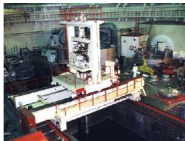
Перевантажувальна машина МРС-1000 над басейном перевантаження енергоблоку № 1
