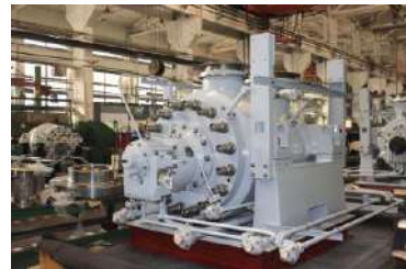
Аварійні живильні насоси, що виготовлені на ПАТ "Насос-енергомаш" (м. Суми, Україна), для енергоблоків № 3 і № 4 Тяньваньської АЕС (Китай)
