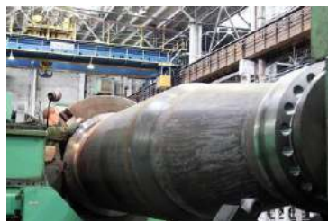
Процес виготовлення колектора парогенератора для Білоруської АЕС на ОАО “Петрозаводскмаш” (м. Петрозаводськ, РФ)
