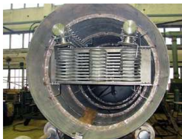
Внутрішня частина барботера із закладними деталями енергоблоку № 2 Ленінградської АЕС-2 (РФ)
