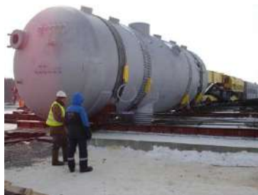
Парогенератор ПГВ-1000М для енергоблоку № 1 Нововоронезької АЕС-2 (РФ)
