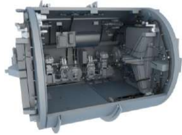
Внутрішній вигляд та компонування обладнання шлюзу основного
