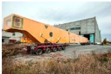
Відвантаження балки полярного крана для енергоблоку № 1 Білоруської АЕС з цеху № 30 АО “Тяжмаш” (м. Сизрань, РФ). Вага балки – 84 т, габаритні розміри – 42,0 x 2,24 x 3,3 м
