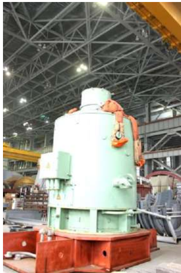
Електродвигун ВА3 215/109-6АМ05 для ГЦН енергоблоку № 1 Нововоронезької АЕС-2 (РФ)
