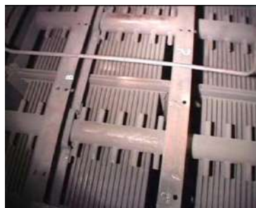
Роздавальні колектори парогенератора ПГВ-1000М
