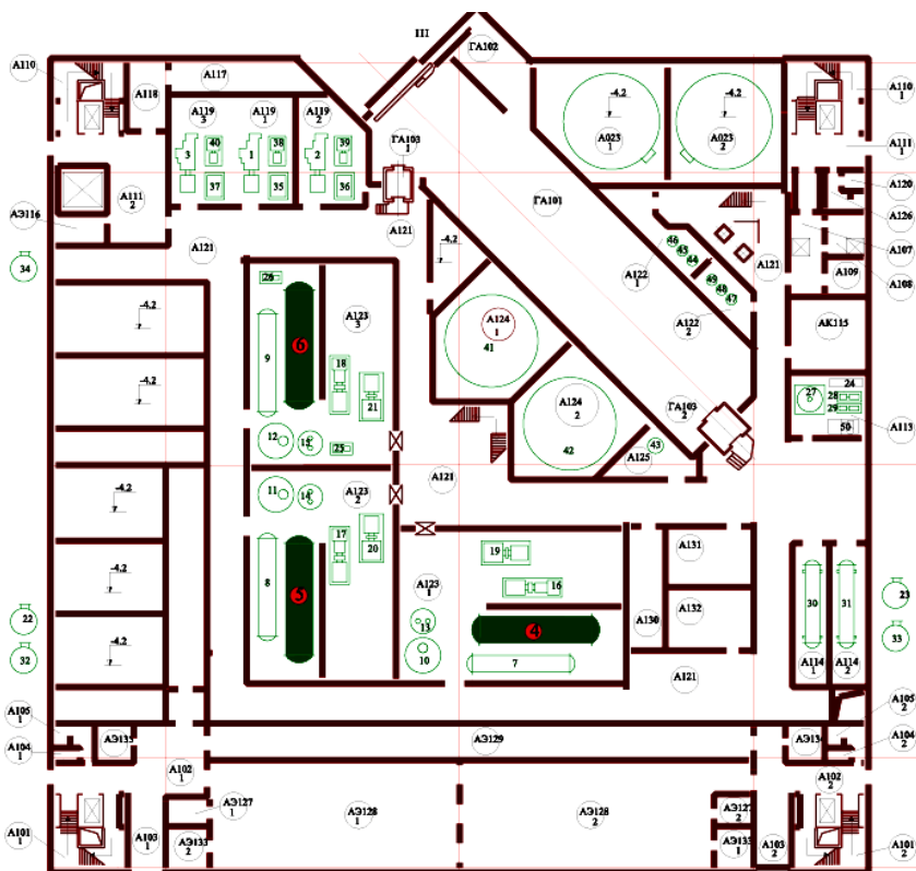
Рис. 7.4. Розташування теплообмінників CAO3 (активна частина) у приміщеннях А-123/1,2,3 на позначці 0,00: 4 – TQ10W01; 5 – TQ20W01; 6 – TQ20W01
