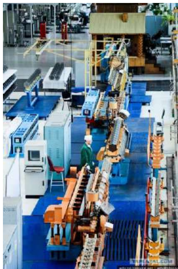
Автоматизовані стени оснащення пучка ТВЕЛів на ПАО “Новосибірський завод хімконцентратів” (м. Новосибірськ, РФ)
