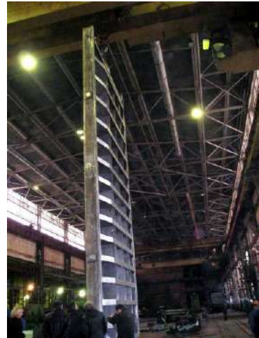
Гідрозатвор з прольотом 1,5 м басейна витримки енергоблока № 3 з реактором ВВЕР-1000 Тяньваньської АЕС (Китай)
