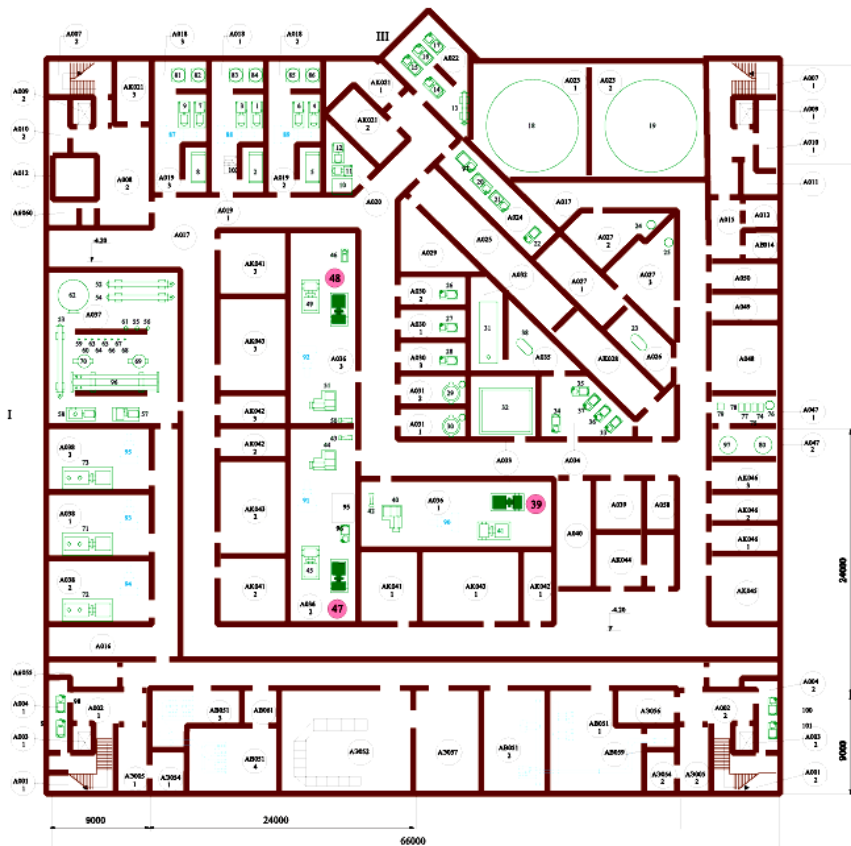
Рис. 7.6. Розташування насосів САОЗ (активна частина) у приміщеннях 036/1,2,3 на позначці + 4,20: 39 – TQ12D01; 47 – TQ22D01; 48 – TQ32D01
