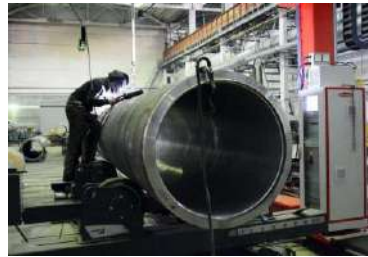
Труба заготовка для виготовлення ГЦТ на ОАО «Петрозаводськ-маш» (м. Петрозаводськ, РФ)
