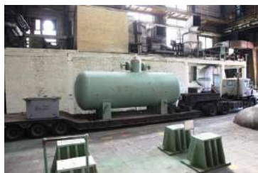
Відвантаження барботера з виробничого майданчика ПАО "ЗиО-Подольск" (м. Подольськ, РФ) для енергоблока № 5 Тяньваньської АЕС (Китай)
