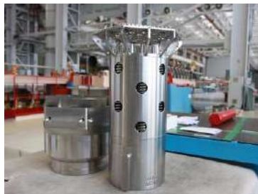
Хвостовик і головка ТВЗ
