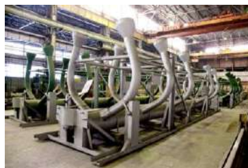
Колектор пари з патрубками парогенератора ПГВ-1000МКП для енергоблоку № 2 Ленінградської АЕС-2 виготовлений на “ЗиО-Подольськ” (м. Подольськ, РФ)
