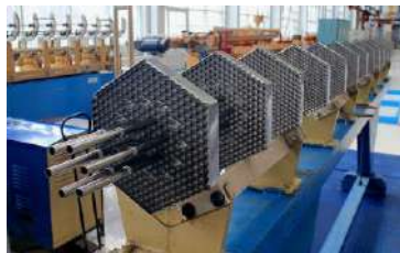
Канали СУЗ з дистанціонуючими решітками на монтажньо-складальному столі цеху № 10 ПАО «Новосибірський завод хімконцентратів» (м. Новосибірськ, РФ)
