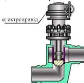
Рис. 7.20. Схема сифонного запірного вентиля
