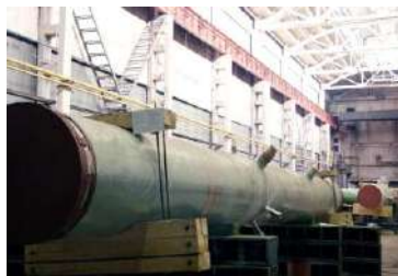
Комплект трубних вузлів ГЦТ енергоблока № 2 Ленінградської АЕС-2 (РФ)
