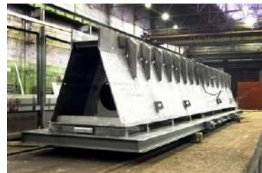
Гідрозатвор та частина закладної рами гідрозатвора енергоблоку № 1 з реактором ВВЕР-1000/446 Бушерської АЕС (Іран)
