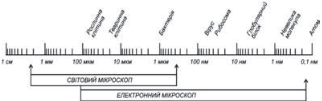
Рис. 1.1. Розміри клітин і клітинних компонентів, а також робочі діапазони світлового й електронного мікроскопів, зображені в логарифмічній шкалі.
