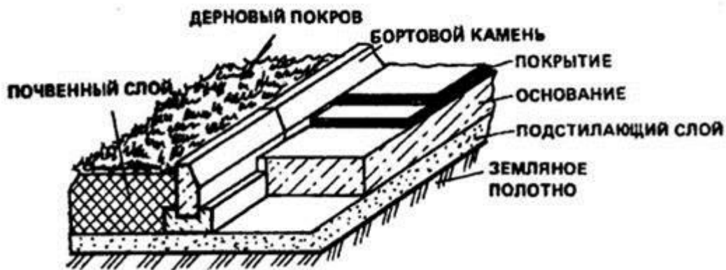
Рис. 8.4.1. Конструкція дорожнього одягу
