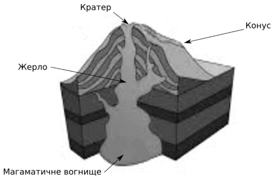
Рисунок 4 — Основні частини вулканічного апарату
