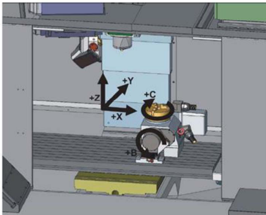
Рис.5.7. Робоча зона та системи координат фрезерно-свердильного верстата
