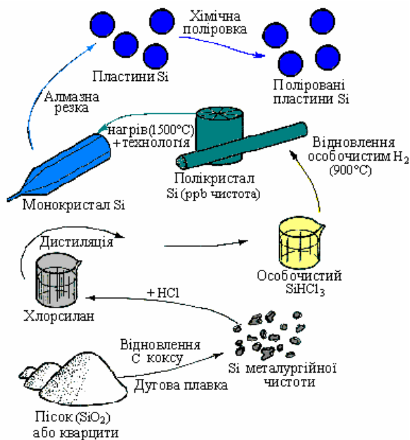
Рисунок 4.2 – Схема отримання напівпровідникового кремнію
