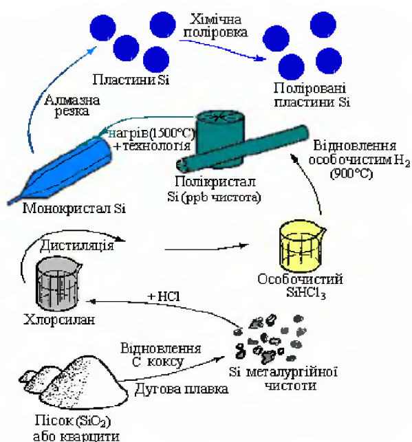
Рисунок 4.2 – Схема отримання напівпровідникового кремнію
