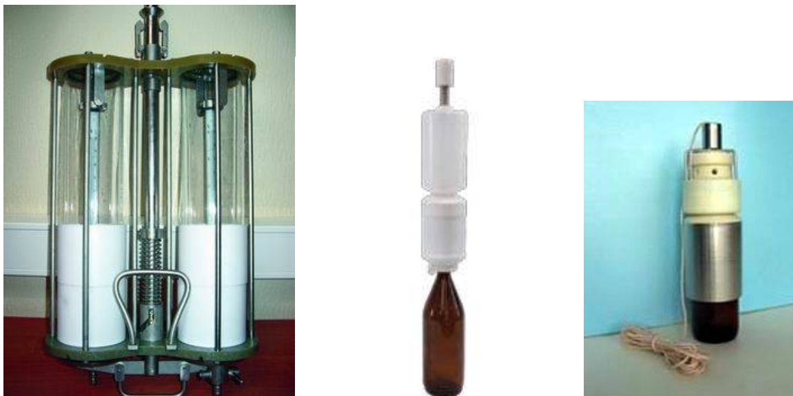
Рис. 5.1. Прилади для відбору проб води: 1 – батометр Молчанова (висота приладу 65 см, об'єм 4 л); 2 – пробовідбірники ПЕ-1220 і 3 – СП-2.
