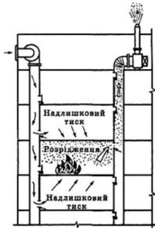
Рисунок 7.13 – Створення безпечних зон за допомогою вентиляційних установок (димовидалення)
