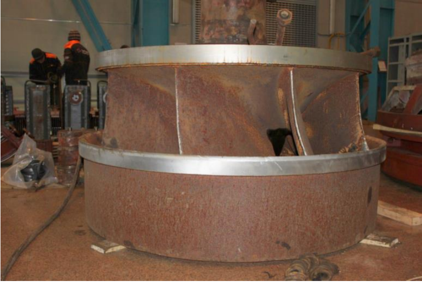
Рисунок 1.3 – Корозійне руйнування поверхні робочого колеса турбіни ГЕС
