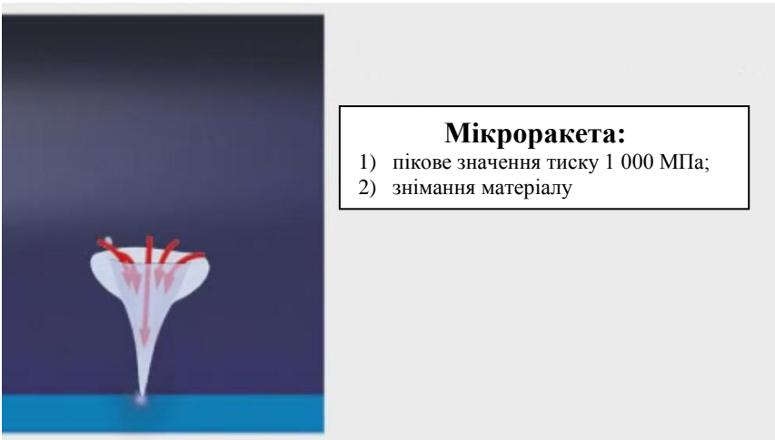
Рисунок 1.7 – Принцип дії кавітації на поверхні обладнання
