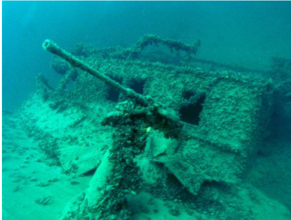
Рисунок 1.12 – Приклад дії молюсків на занурені у воду деталі машин
