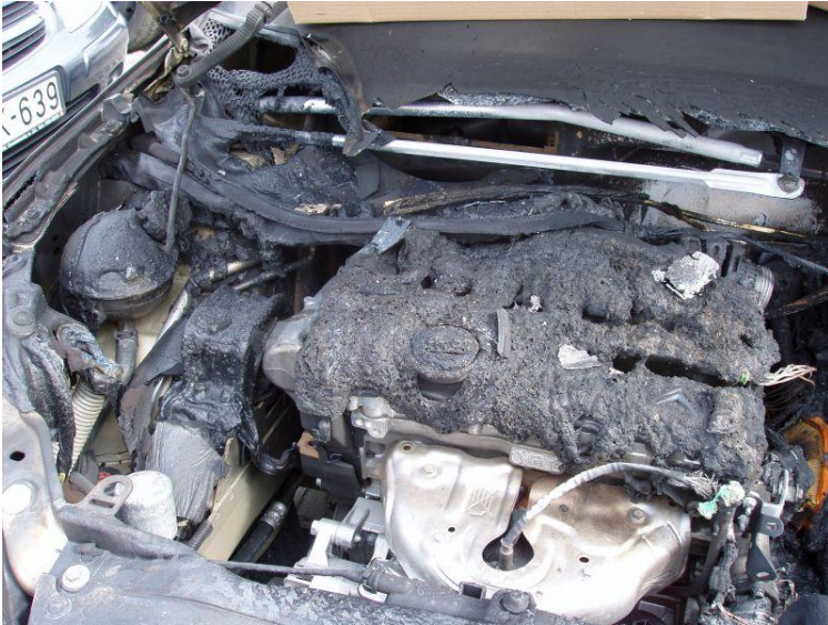
Рисунок 1.9 – Наслідок перегрівання деталей машин (двигун автомобіля Citroen C4, на якому проїхали 220 км на першій передачі)
