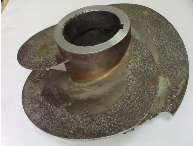
Рисунок 2.3 – Кавітаційне зношення робочого колеса
