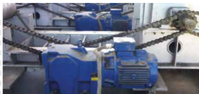
Двигатели с коническим редуктором для цепных подающих столов в холодильниках прокатных станов
