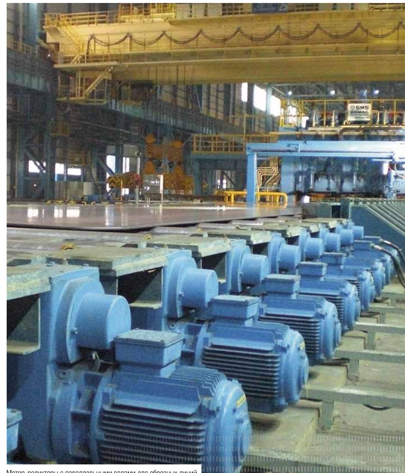
Мотор-редукторы с параллельными валами для обрезных линий
